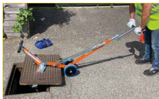
Utilizzo 2: sollevamento con leva pieghevole APS90 - APS80.
