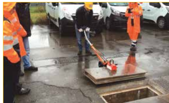
Utilizzo 1: impiego necessario in presenza di chiusini eccessivamente pesanti o logorati.
