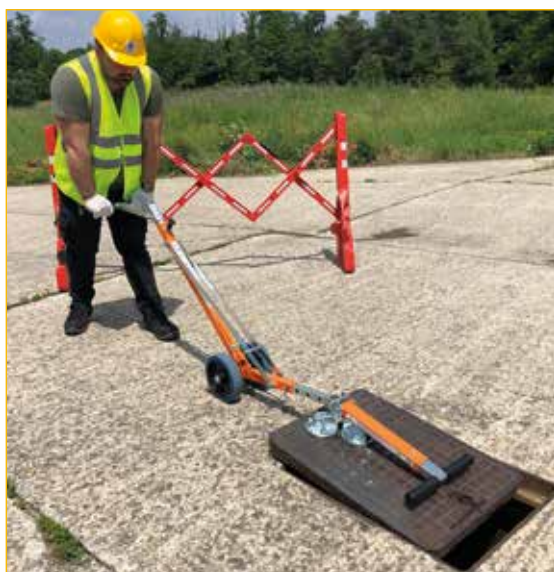
Utilizzo 2: sollevamento con leva pieghevole APS90.
